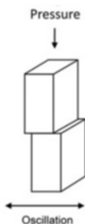
Rys. 5. Schemat procesu LFW z najważniejszymi parametrami i optymalnym układem geometrii łączonych elementów
