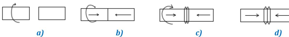
Rys. 3. Etapy wyróżniane w cyklu zgrzewania tarcioowego ze stałą prędkością obrotową: a) nadanie jednemu z prętów prędkości obrotowej, b) zbliżenie powierzchni czołowych prętów i dociśnięcie ich, c) zwiększanie siły docisku pręta obracającego się do pręta nieruchomego, d) utrzymanie docięnięcia prętów dużą siłą o stałej wartości przy równoczesnym skracaniu długości prętów wskutek powiększania wypłytki
